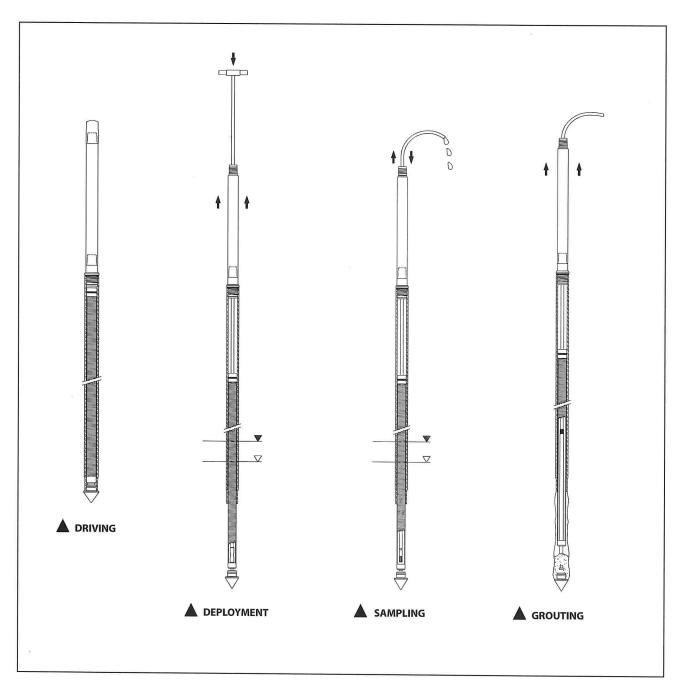
**GEOPROBE® SCREEN POINT 15 GROUNDWATER SAMPLER**
